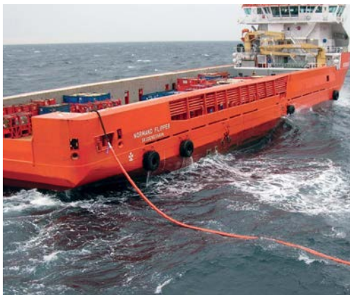
写真 6. オイルの移送
