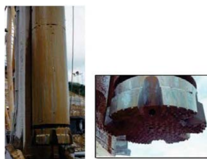
図 2.2 全断面 DTH ハンマー工法
