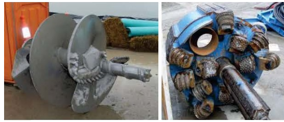
図 1.6 スティンガーを装備した 削孔ツール
