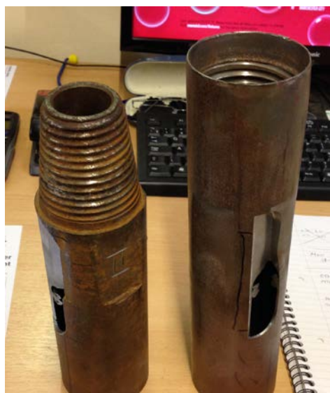
写真1. API規格のロッドの摩耗状況
