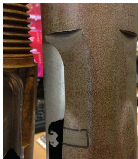
写真2. API規格ロッドのスパナ一部 摩耗状況
